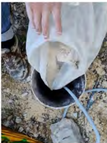
cuttings pour enrober les sondes d'humidité
