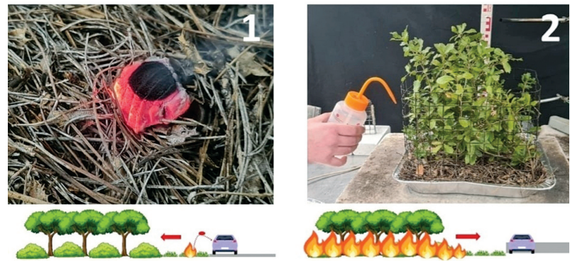
Fig. 4 (ci-dessus) : Illustration des deux protocoles de brûlage : 1 – ignition, 2 – propagation.
