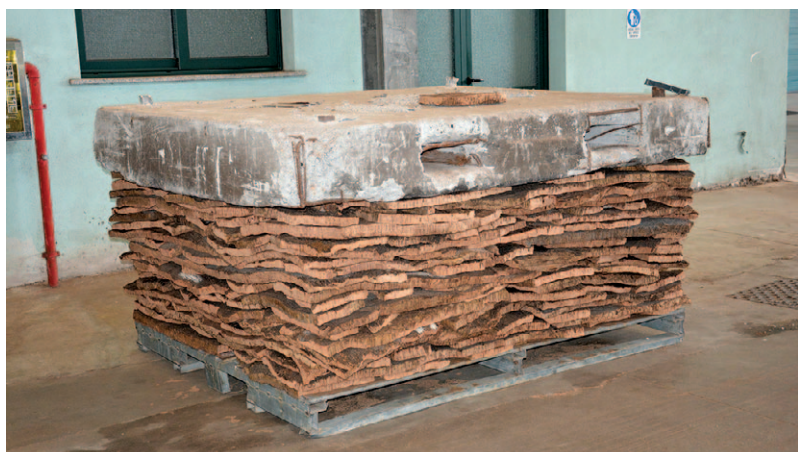
Photo 11 : Les plaques de liège sont aplaties sous le poids d'une dalle avant utilisation. Photo J.D.
