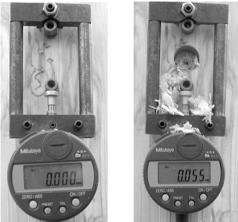
Fig. 2 (ci-dessus) : Vue du capteur avant et immédiatement après le percement du trou. L'apparition de cette cavité a pour conséquence d'atténuer une partie des contraintes. La technique utilisée pour l'estimation des DRL repose sur la méthode dite du "trou unique". Cet essai mécanique s'appuie sur le principe suivant : à géométrie de capteur fixée, plus la contrainte est grande, plus les pointes s'écartent lors du perçage. Comme le montre l'affichage, la distance entre les deux pointes a augmenté de 55 µm à la suite du percement.
