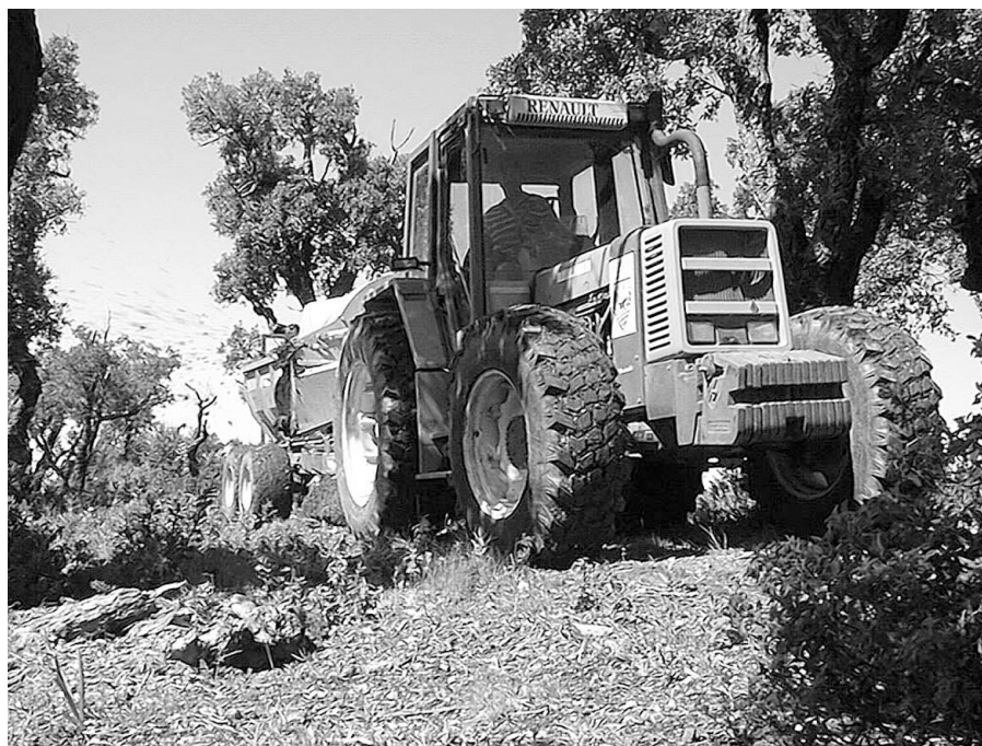
Photo 1 : Epandage sylvicole de boue pâteuse à Collobrières. Les boues sont émiettées finement avant d'être épandues.
