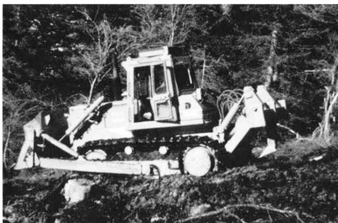
Photo 2 : Travaux préparatoires : sous-solage sur pente faible. Photo ONF/ Thierry Triballier
