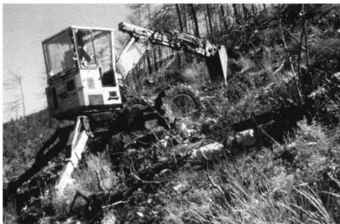
Photo 3 : Travaux préparatoires : confection de potêts à la pelle araignée sur pente forte Photo ONF/ Thierry Triballier
