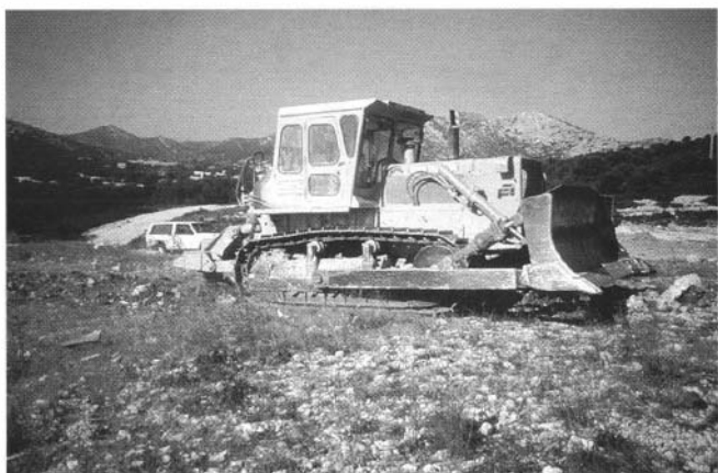
Photo 1 : Technique du sous-solage.
