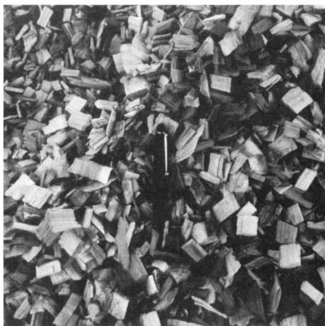
Photo 3 : Spello - copeaux d'eucalyptus pour le système d'alimentation de la chaudière.
