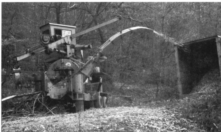
Photo 2 : Rincine - Chargement de copeaux pour l'installation de chauffage de l'usine.
